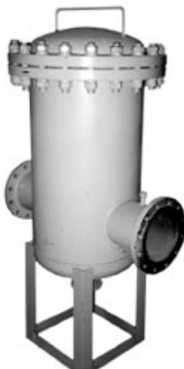
**Фильтры газовые ФГ-50** предназначены для очистки неагрессивных газов и воздуха от влаги и механических примесей. Фильтрующий элемент — полимерный ЭФВ, который сохраняет все технические характеристики при температуре окружающей среды от -60 до +55 °С и относительной влажности воздуха до 100 %.
